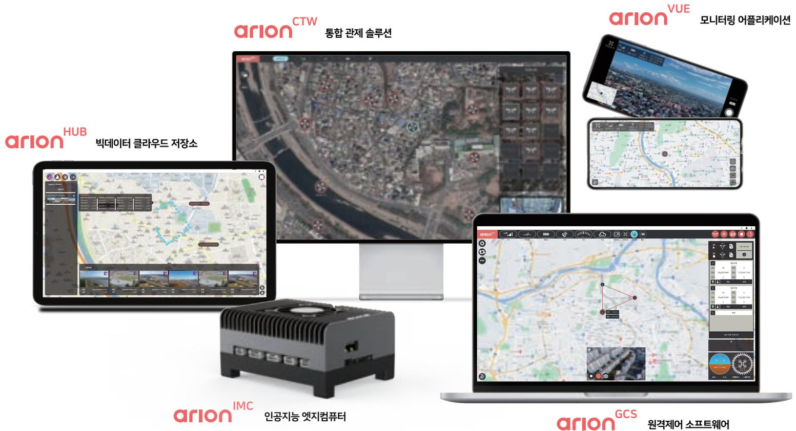
무인이동체의 고도화된 작업 수행을 위한 엣지컴퓨터 “아리온IMC”를 시작으로 무인이동체를 원격 관제 할 수 있는 “아리온GCS”, 무인이동체의 데이터 기록 저장 및 관리를 위한 “아리온HUB”, 다수의 무인체 모니터링이 가능한 “아리온CTW”, 어디에서든 무인이동체의 정보를 실시간으로 모니터링이 가능한 어플리케이션 “아리온VUE”를 개발하여 “아리온”이라는 DaaS(Drone as a Service) 플랫폼을 개발
